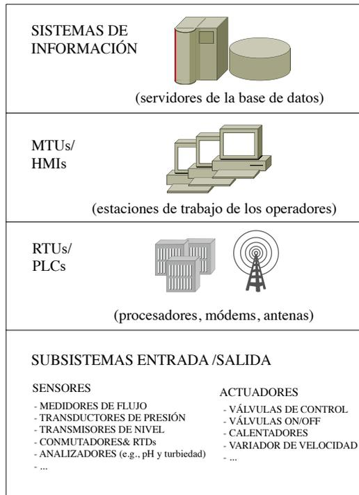
Figura 1: Elementos de un escenario SCADA de ejemplo
